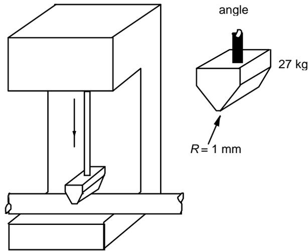
Figure 5 : Impact test
