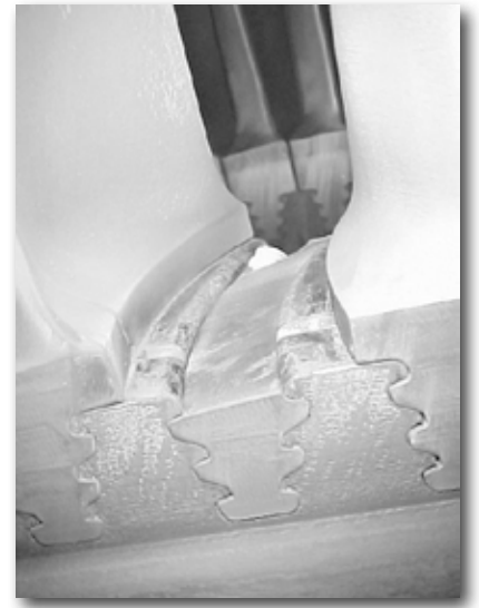
Fracture complète du talon d'aube en service
