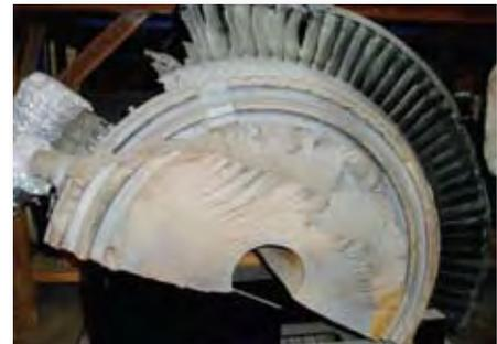
*Défaillance du rotor de turbine*
