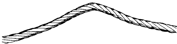
Deformação em cabo de aço
